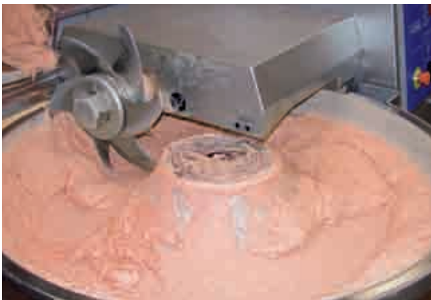
Nel cutter: impasto per salsiccia da lessare compatto, prodotto con l'ausilio di sale da cucina.
